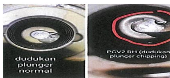
Gambar 4. Perbandingan dudukan plunger normal dan chipping .
