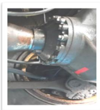
Gambar 2. Differential HD785-7 yang mengalami kebocoran
