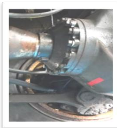
Gambar 2. Differential HD785-7 yang mengalami kebocoran
