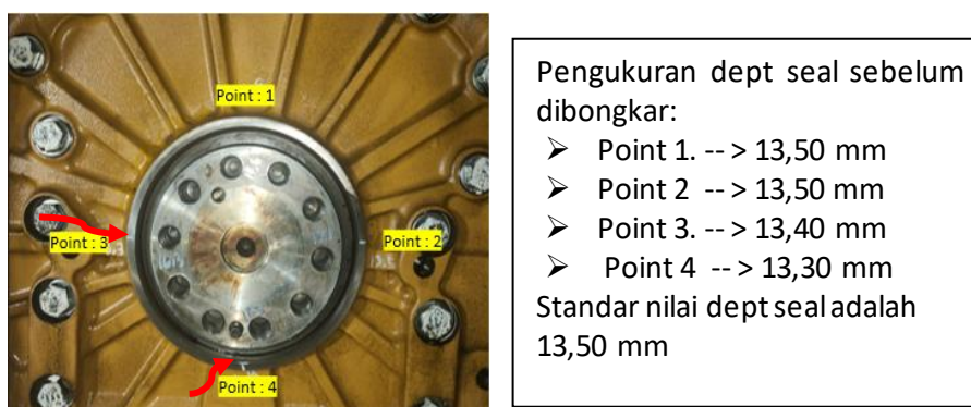
Gambar 1. Dept seal dan hasil pengukuran dept seal
