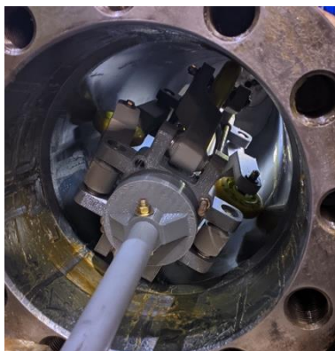
Gambar 8. Wireless borescope pada saat kontak dengan silinder hidrolik
