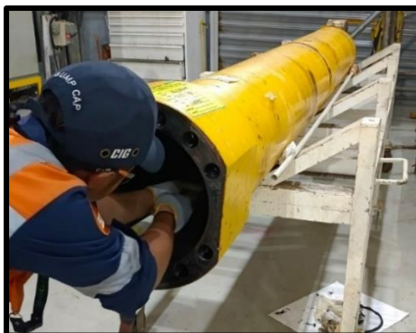
Gambar 2. Proses pembersihan dan inspeksi visual inner cylinder
