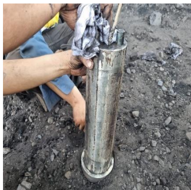
Gambar 7. Membersihkan pin bogie
