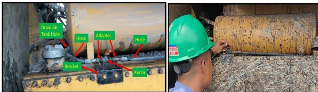
Gambar 5. Hasil reposisi drain air tank valve pada unit OHT CAT 777E
