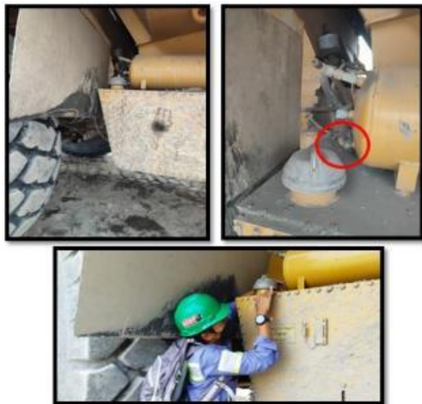
Gambar1. Lokasi katup pembuangan air sebelum reposisi
