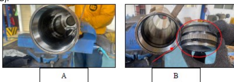
Gambar 8. Kerusakan pada Parking brake accumulator
