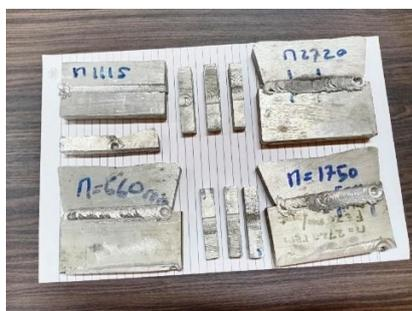
**Gambar 6.** Benda uji untuk pengujian impak *charpy*, kekerasan *vickers*
